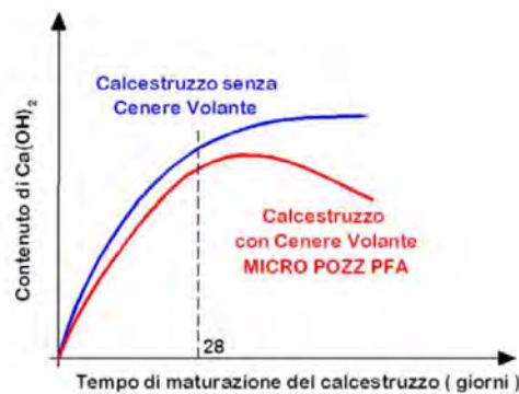
Fig. 38. Riduzione della porosità e delle efflorescenze nel calcestruzzo per minor contenuto di \text{Ca(OH)}_2 libero. Fonte: [o]
