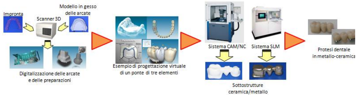
Figura 1.4.2.1 – Esempio di impiego di tecnologie CAD/CAM e SLM
