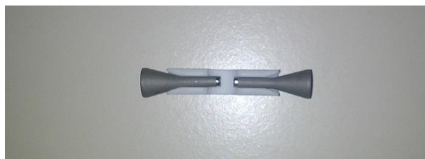
Figura 3.2.6.1 – Esempio di provino portato a rottura
