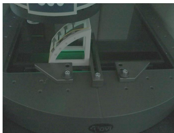
Figura 3.2.3.1 (b) – Esempio di posizionamento dei provini sul supporto di gesso e di misurazione
