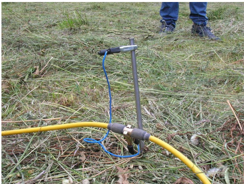
Fig. 3.15: Contatto elettrodo-cavo attraverso il morsetto.
