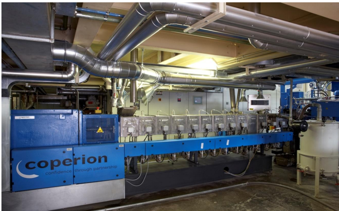
Figura 2.5 Estrusore per il metodo one shot diretto. Da sinistra si nota il motore, il sistema di immissione dei reagenti, il corpo dell'estrusore nella parte centrale e infine la zona che porta al taglio.
