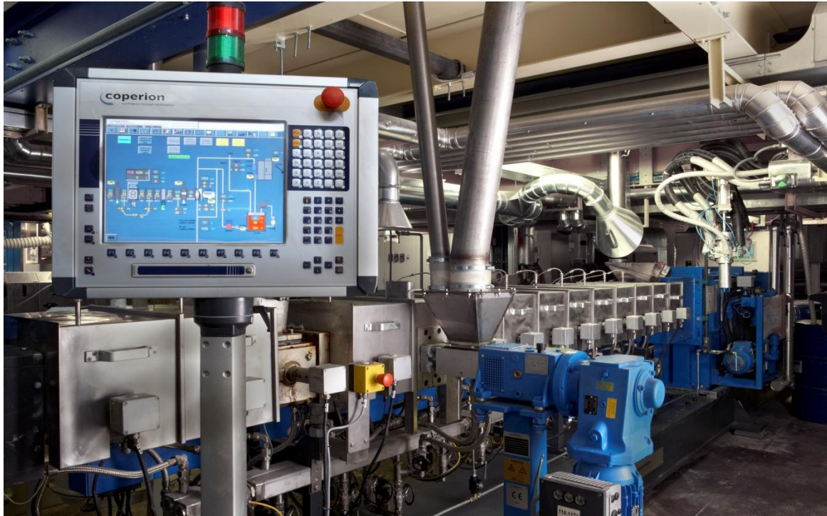
Figura 2.4 Estrusore operante secondo il metodo one shot diretto e relativo monitor per il controllo dei dati di processo.
