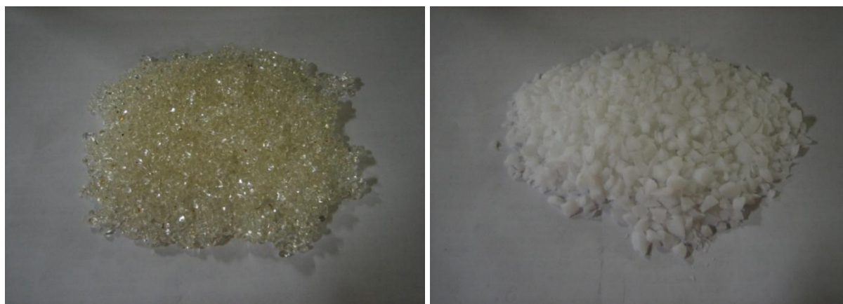
Figura 2.1 Granulo di TPU ottenuto da one shot diretto. Figura 2.2 Chips ottenute da macinazione del biscotto.
