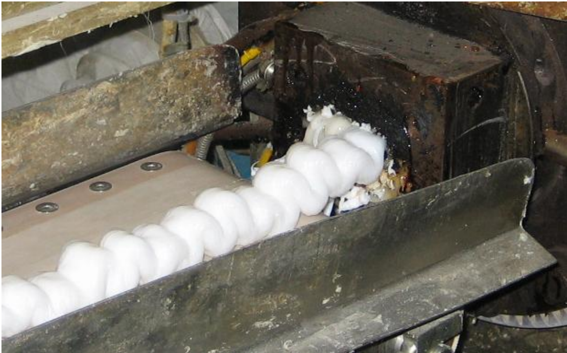
Figura 2.6 Particolare di un estrusore operante secondo il metodo due step nel quale si vede l'uscita del "biscotto" sul nastro trasportatore.
