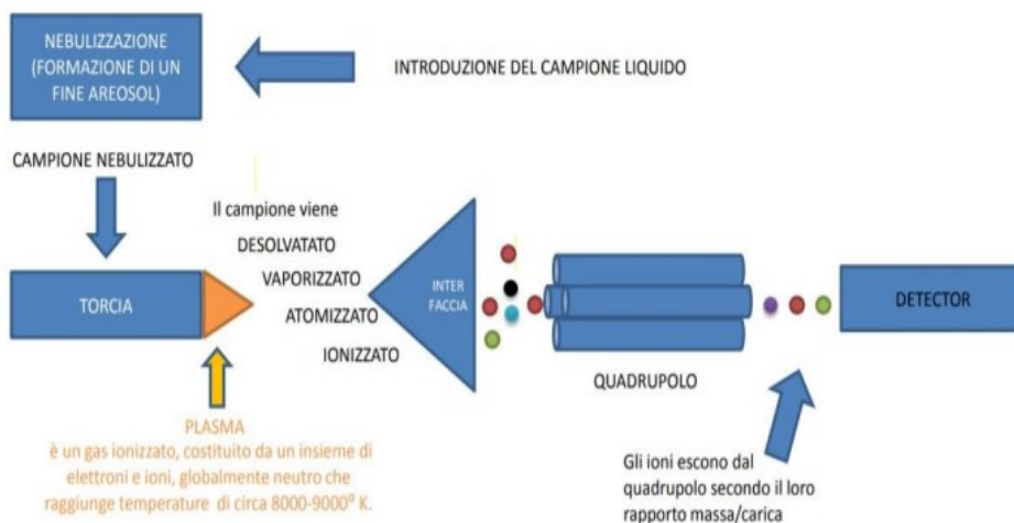
Figura 3.9 Schema a blocchi del funzionamento dell'ICP-MS.
