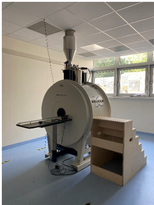
Figura 4.22 Rappresentazione del sistema Bruker con cui sono state effettuate le misure MRI dei campioni di NP.
