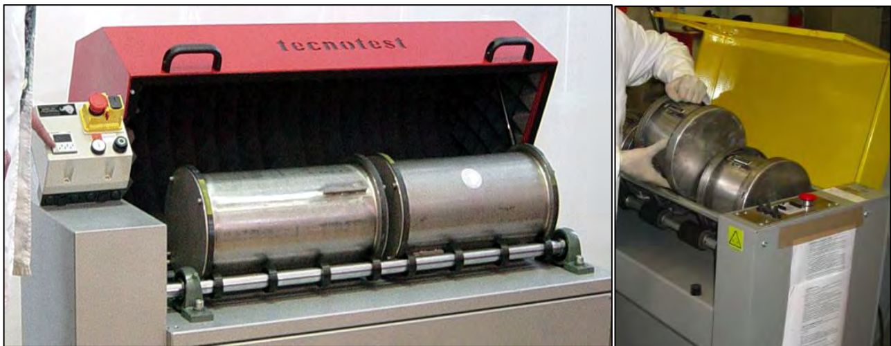
Figura 3.5. Strumento utilizzato per il test all'usura "Micro-Deval"
