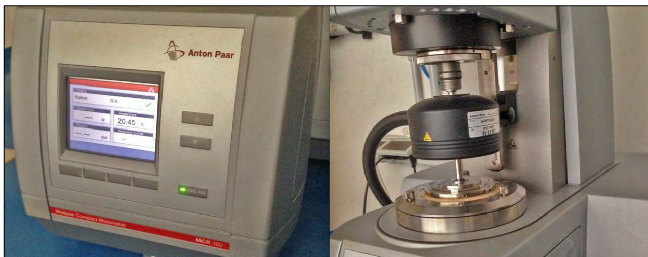
Figura 6.7. Reometro Anton Paar M.C.R. 302
