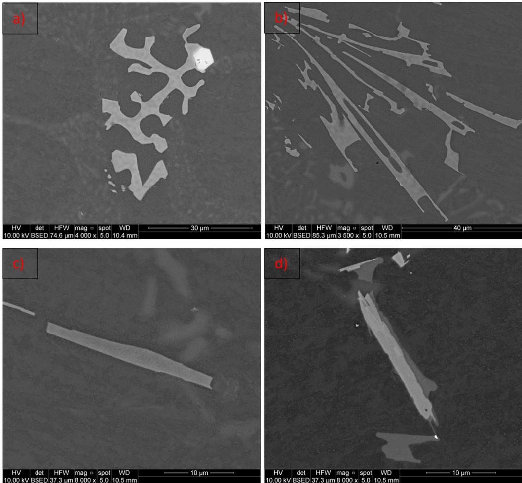
Figura 6.11: Le immagini illustrano i vari composti ricchi in ferro individuati; a) provino HC5, fase alfa con morfologia a stella, b) provino HC1, fase ramificata, c) provino HC5, aghetto di fase beta, d) provino HC5, aghetto beta in cui è nucleata la fase  $\pi$ .
