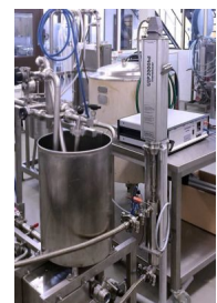
Figura 2.8: Dispersore a ultrasuoni per l'esfoliazione del grafene
