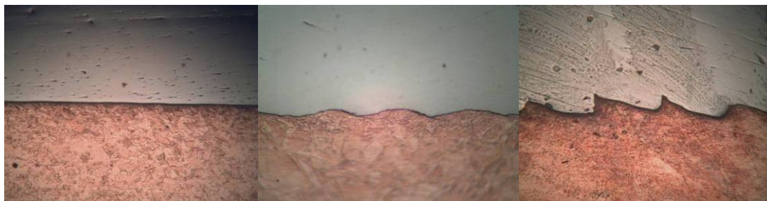
Figura 6: diverse tipologie di interfacce di saldatura.
