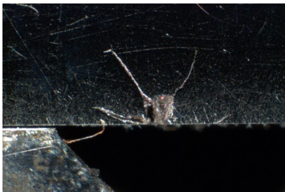
Figura 9: cricca superficiale nel provino .6
