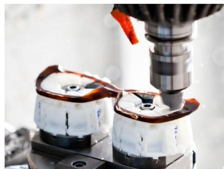
*Figura 1.4 Lavorazione interne del frontale eseguite con pantografo CNC*
