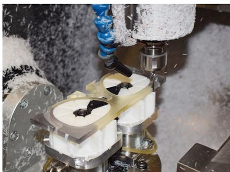
*Figura 1.3 Lavorazione di sgrossatura del frontale eseguita con pantografo CNC*
