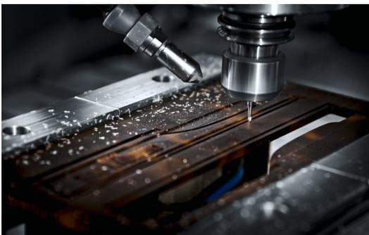
*Figura 1.6 Lavorazione di pantografatura delle aste*
