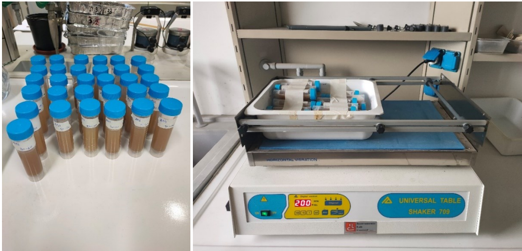
Fig. 4.1: Preparazione dei campioni per l'analisi diffrattometrica (Provette Falcon da 50 ml).
