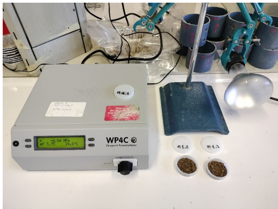
Fig. 4.9: Strumento WP4C in funzione, a destra due sub-campioni in attesa della misura.
