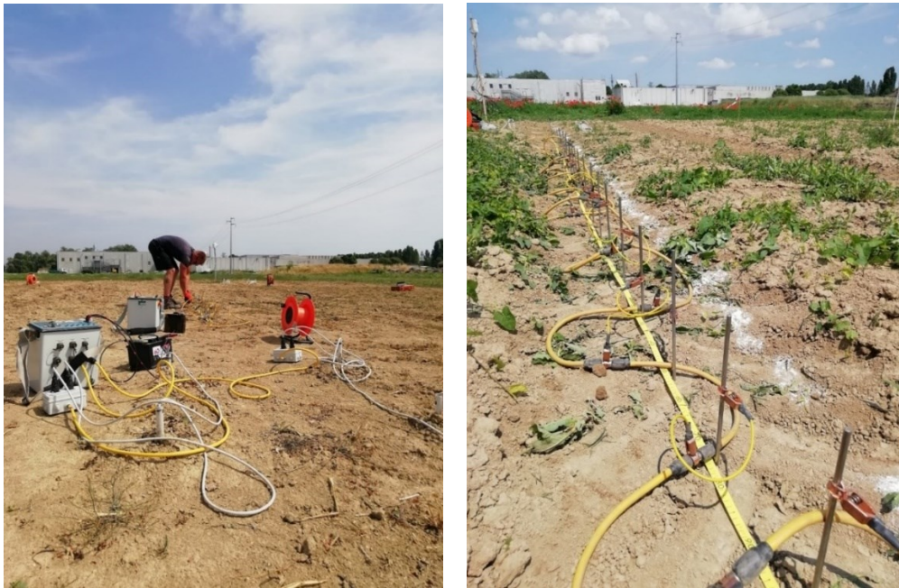
Fig. 3.10: Posa in campo delle linee di acquisizione 2D, i picchetti sono equidistanziati e collegati con dei cavi multipolari al georesistivimetro.
