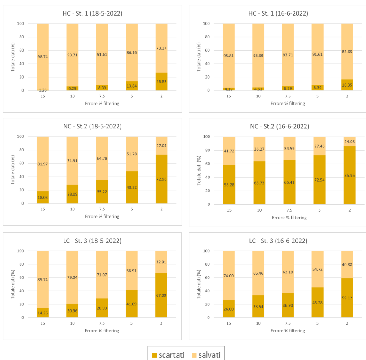
Fig. 3.19: Percentuali di quadrupoli salvati e scartati per ciascuna soglia di errore, per le prime tre stazioni in data 18 maggio e 16 giugno.
