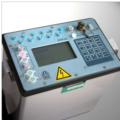
Fig. 3.13: Georesistivimetro Syscal Pro, Iris Instruments (immagine di Iris Instruments)
