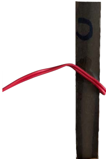
(d) Incollaggio dei cavi sul retro del provino
