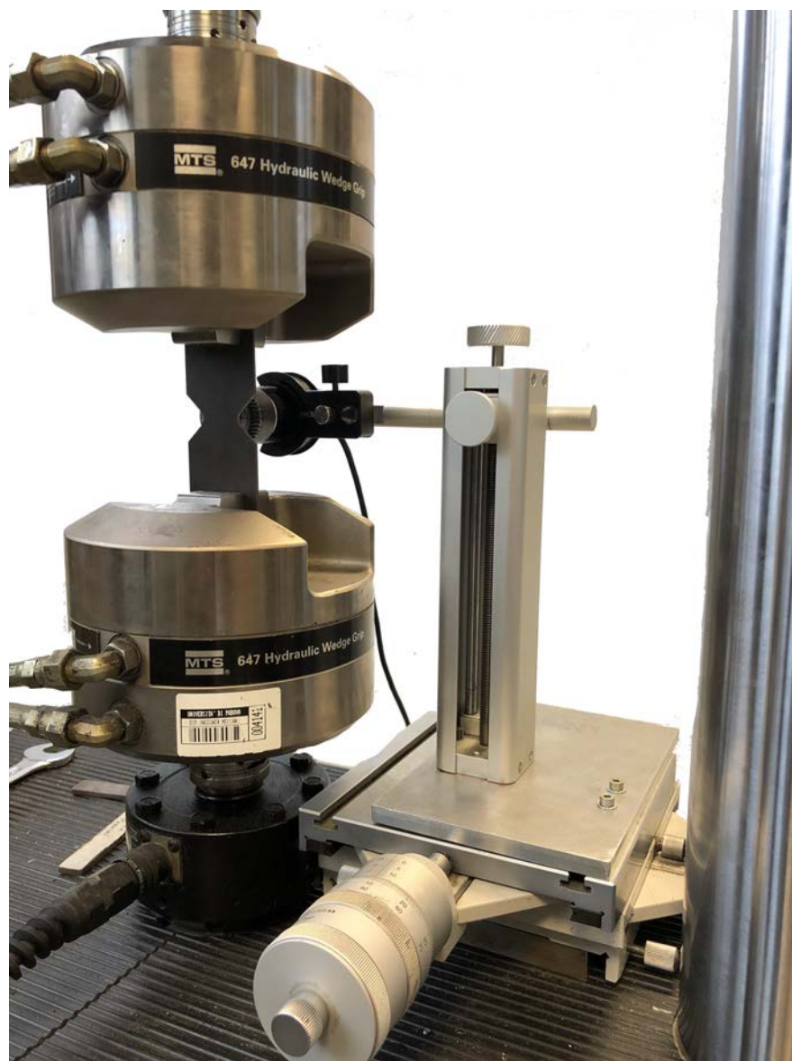
Figura 6.6: Setup utilizzato per il monitoraggio delle prove a fatica
