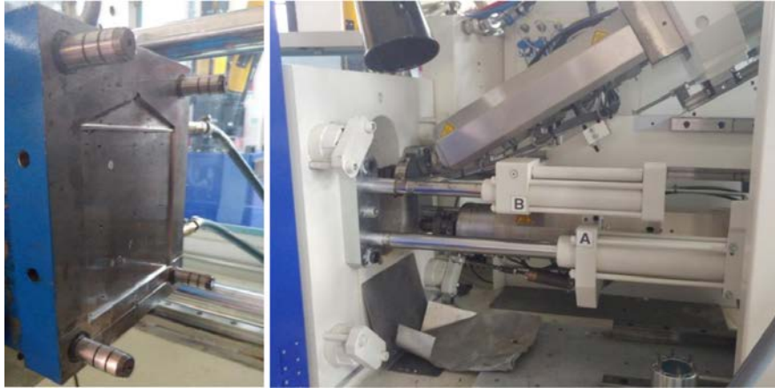
Figura 3.4: Stampo della piastra(sinistra) e gruppo di iniezione(destra)
