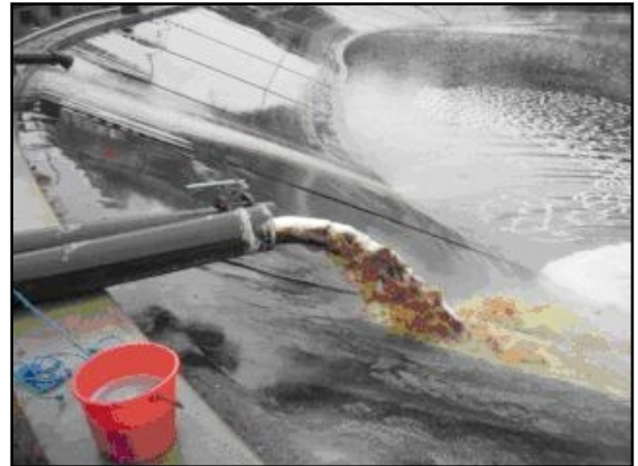
Figura 4.1 = esempio di percolato
