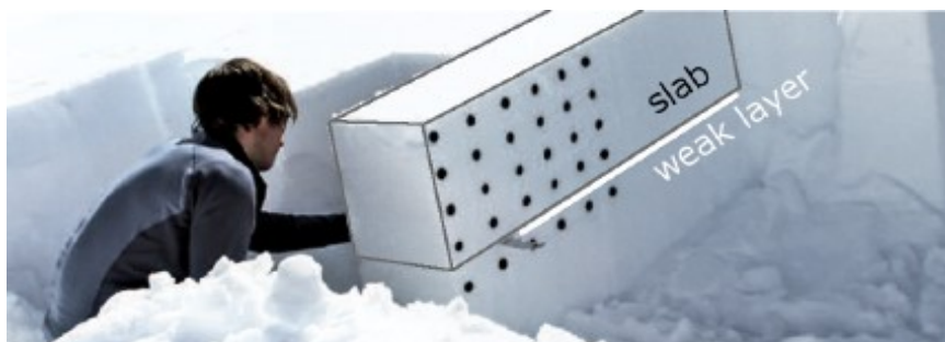
Figura 1.15 - Propagation saw test (PST). I punti neri sono i marcatori utilizzati per il tracciamento delle particelle (PTV) per misurare la deformazione del lastrone (Gaume et al., 2017b).
