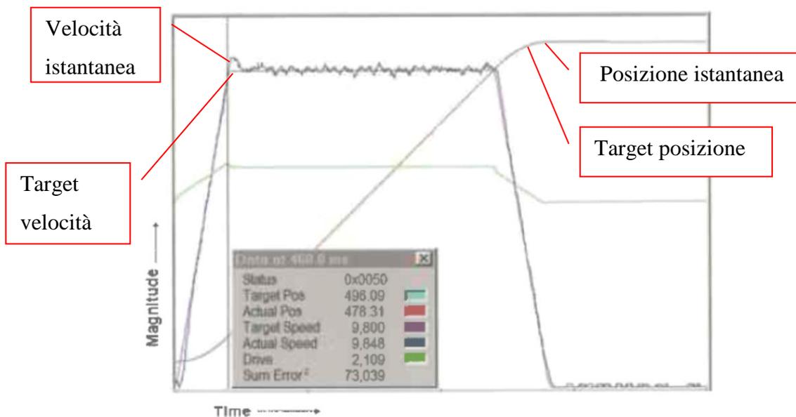
Figura 2.5 Esempio di controllo del sistema con guadagni P, I, D e dei feedforward di velocità ed accelerazione
