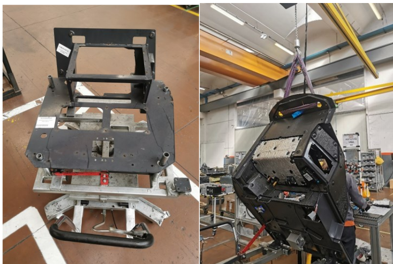
Figura 7.1 Scenario AS IS - A sinistra il carrello; A destra la sua inclinazione possibile solo con gru a bandiera
