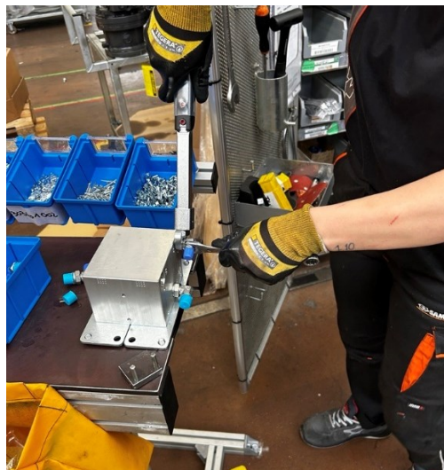
Figura 7.26 Pedipolatore in fase di montaggio sulla dima con geometria caratteristica del pezzo
