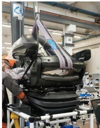
Figura 7.14 Sollevamento sedile tramite funi e gru a bandiera
