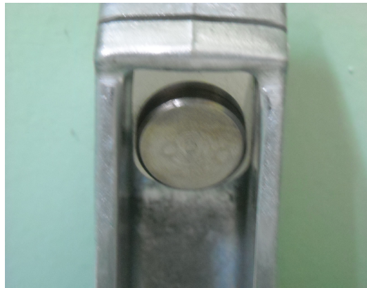
Illustrazione 3.2: Particolare dello scivolo di deflusso con otturatore basculante e peso.
