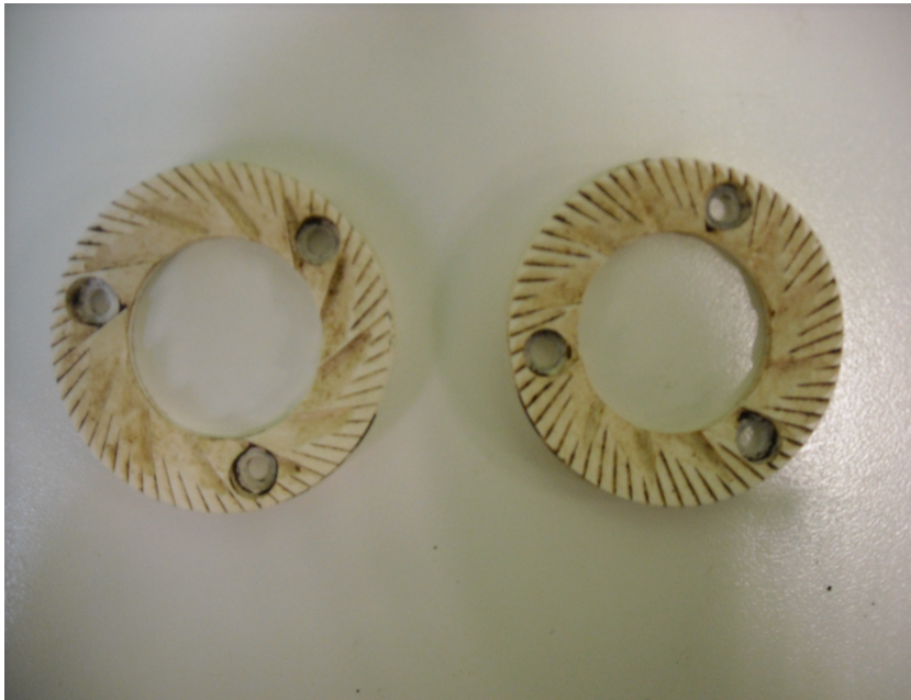
Illustrazione 2.3: Macine in ceramica: a sinistra quella High Performances a destra quella standard.
