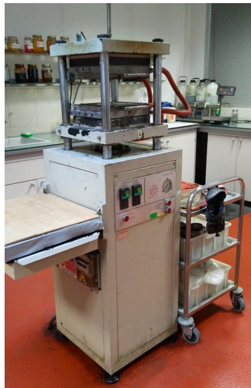
Figura 3.8 – Pressa a caldo del laboratorio tecnologico di Aristoncavi;
