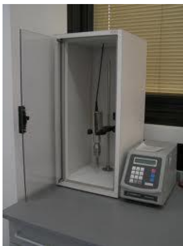
Figura 4.7 - Sonicatore VC505 ® prodotto dalla Sonics Vibra-Cell;
