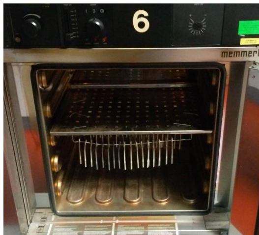
Figura 3.17 – Provini appesi in stufa per invecchiamento termico;
