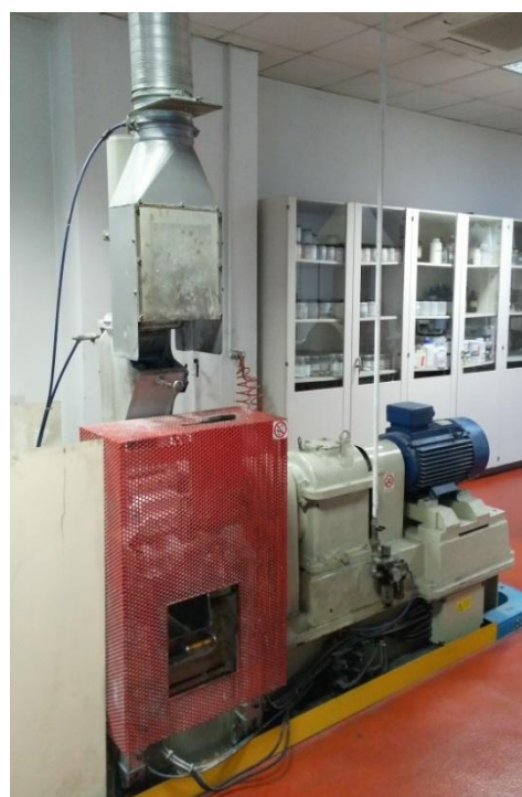
Figura 3.6 – Mescolatore chiuso Banbury del laboratorio tecnologico di Aristoncavi;
