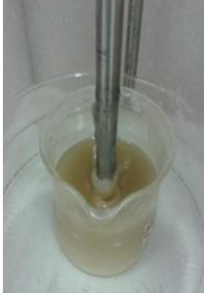
Figura 4.9 – Visibile aumento di viscosità in una miscela sonicata D72T-DIDP;
