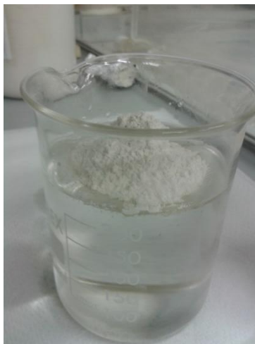
Figura 4.8 – Dellite 72T in polvere addizionata al DIDP;
