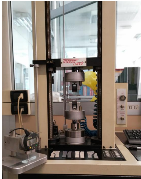
Figura 3.12 – Dinamometro impiegato per la prova a trazione del laboratorio tecnologico di Aristoncavi;
