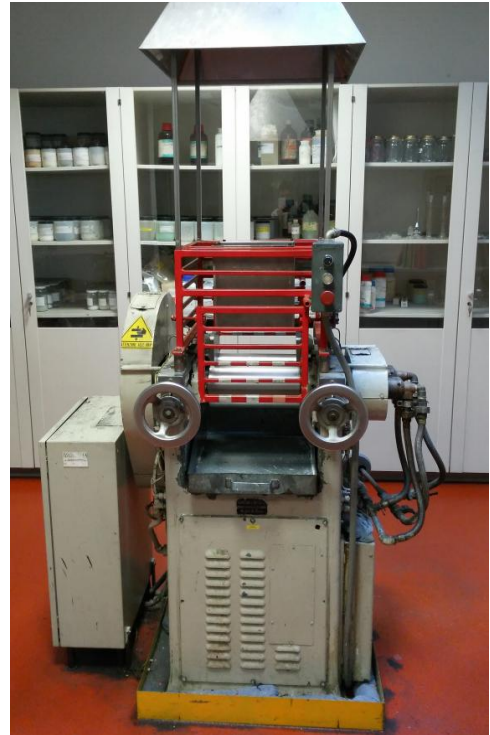
Figura 3.7 – Mescolatore aperto del laboratorio tecnologico di Aristoncavi;
