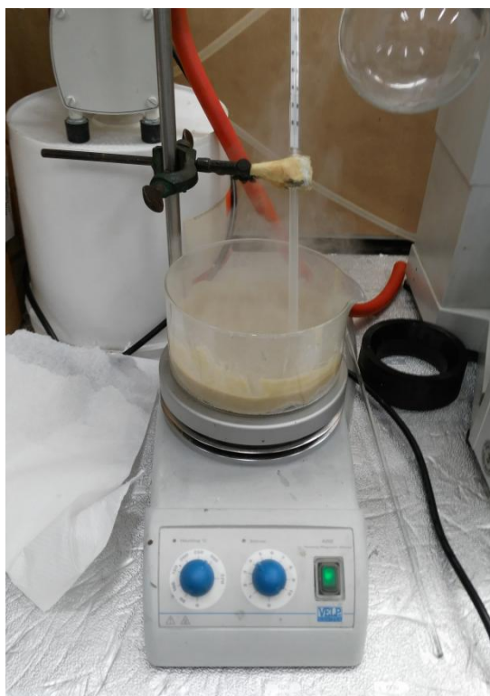
Figura 6.8 – Strumentazione utilizzata per l'evaporazione di EG: piastra riscaldante magnetica con termometro;
