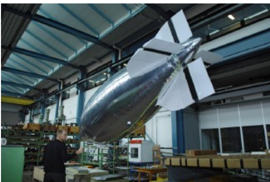
Figura 1.1d. Timoni e stabilizzatori di un dirigibile mossi da EAP [1].
