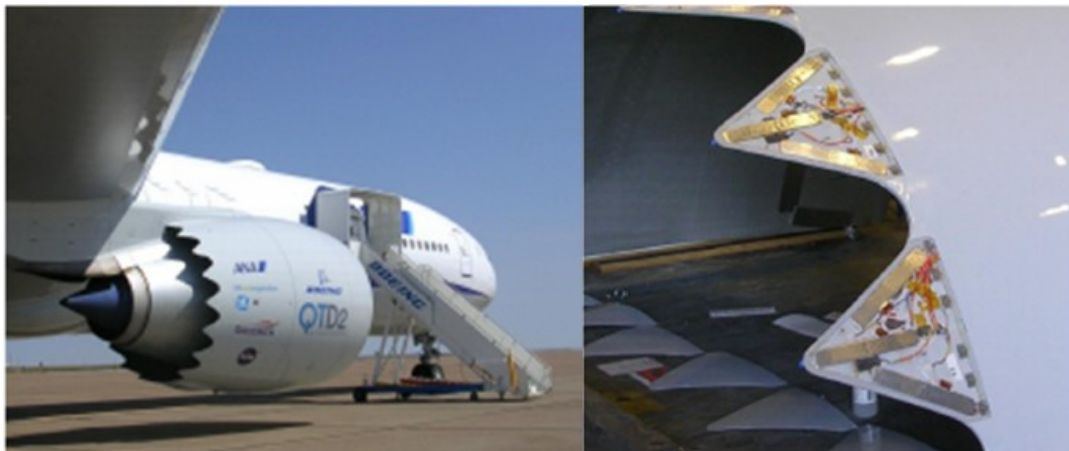
Figura 1.1c. Impiego di shape memory alloys sui "chevrons" di un Boeing 777-300ER [1].
