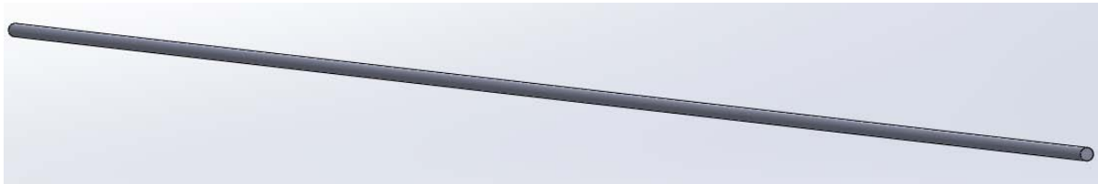
Figura 4.3. Cavo cilindrico lungo 200 mm e diametro 0.5 mm.
