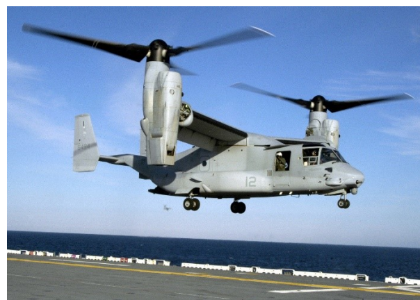
Figura 1.5. Decollo verticale di un convertiplano [9].
