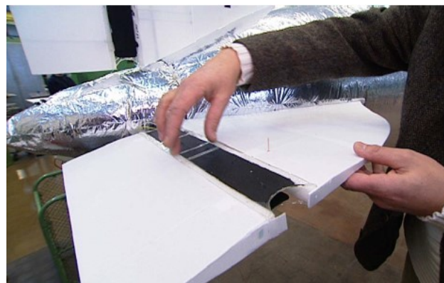
Figura 1.32. Active hinge in EAP della superficie di controllo di uno stabilizzatore di un dirigibile [36].
