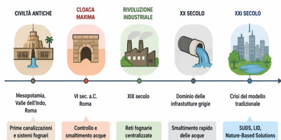
Figura 9 – evoluzione storica dei sistemi di drenaggio urbano: evoluzione storica dei sistemi di drenaggio urbano dalle prime opere di canalizzazione nelle civiltà antiche alla transizione verso soluzioni sostenibili e nature – based.
