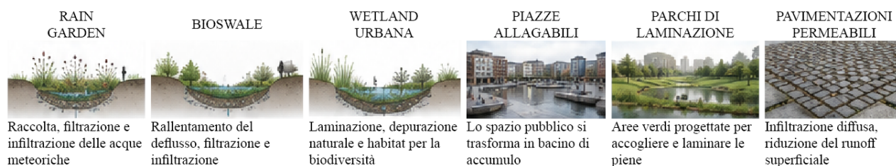
Figura 18 - Principali dispositivi della città spugna per la gestione sostenibile delle acque meteoriche. Rain gardens, bioswales, wetlands urbane, piazze allagabili, parchi di laminazione e pavimentazioni permeabili favoriscono la ritenzione, l'infiltrazione e il rallentamento del deflusso, contribuendo alla riduzione del rischio idraulico e all'incremento della resilienza urbana.
