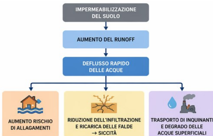
Figura 11 - Effetti del drenaggio rapido sul ciclo idrologico: effetti del drenaggio rapido, aumento degli allagamenti, riduzione della ricarica delle falde e trasporto di sostanze inquinanti verso i corpi idrici.
