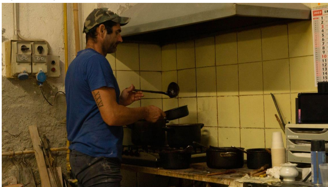
Fig. n. 22 Artigiano della Fonderia Artistica Versiliese intento a liquefare la cera Fotografia di Diego Lorieri, 2023
