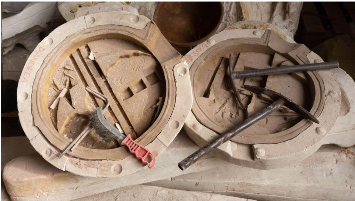
Fig. n. 20 Stampo negativo in silicone e guscio - madre forma - in gesso. Fotografia di Diego Lorieri, 2023
