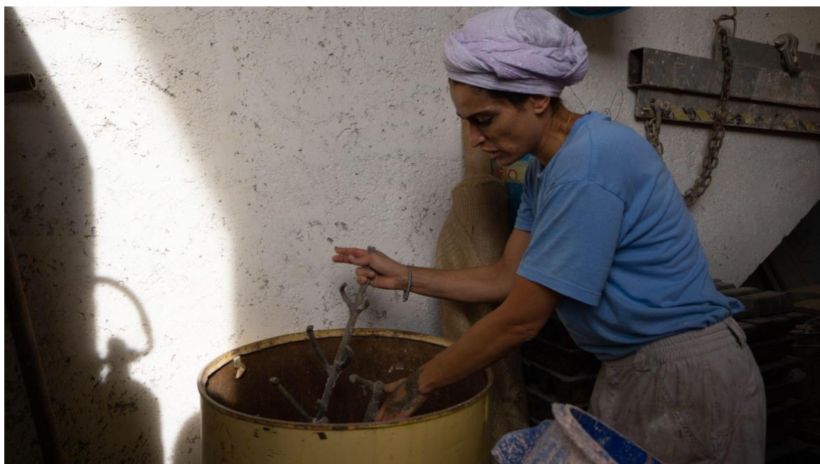
Fig. n. 28 L'artista-artigiana Valentina Lucarini Orejon mostra i canali di colata a seguito del passaggio e della solidificazione del bronzo. Fotografia di Diego Lorieri, 2023
