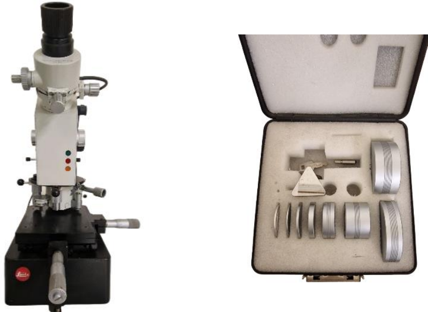
Figura 2.38 Microdurometro Leitz con pesi disponibili. In particolare, sono visibili: 10,15,25,50,100,200,300,500 gf.
