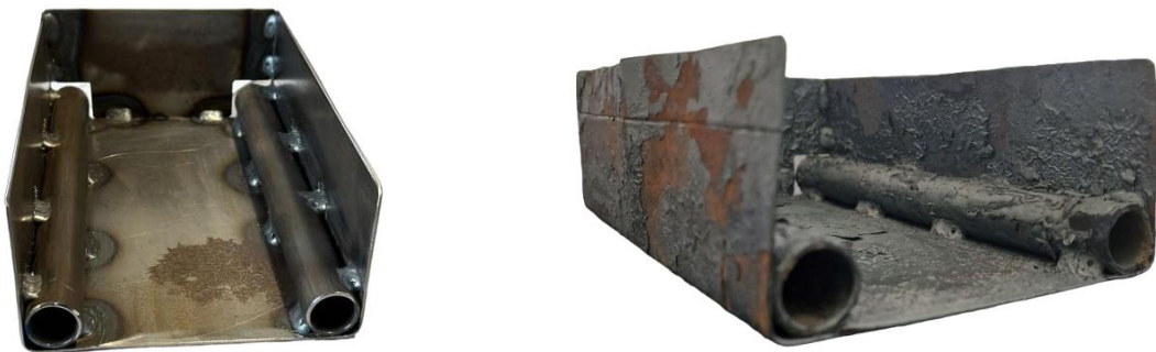
Figura 3.3 Setup in acciaio: a destra, è possibile visionare l'ossidazione dovuta ai trattamenti termici
