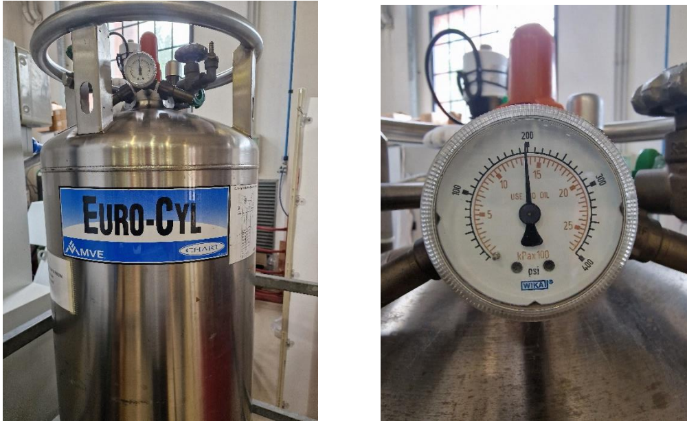
Figura 3.43 Dewar contenente LN 2 e valvola per visionare la pressione interna
