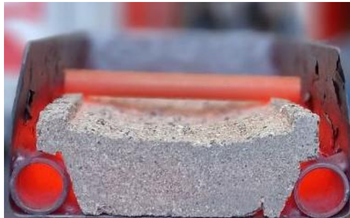
Figura 3.4 Visione della struttura ideata subito appena uscita dal forno. In figura è possibile distinguere il setup, il materiale refrattario lavorato e la barra, di colorazione rossa.
