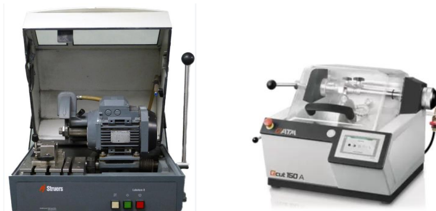
Figura 2.21 Troncatrici usate per il taglio dei campioni della lega di Titanio Ti6Al4V. (a)Troncatrice della ditta Struers, modello Labotom-3; (b) Troncatrice della ditta QATM, modello Brilliant 210 A.
