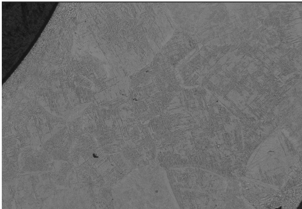
Figura 2.35 Microstruttura lamellare ottenuta attraverso la tempra in aria naturale dopo un tempo di ricristallizzazione di 10 minuti.
