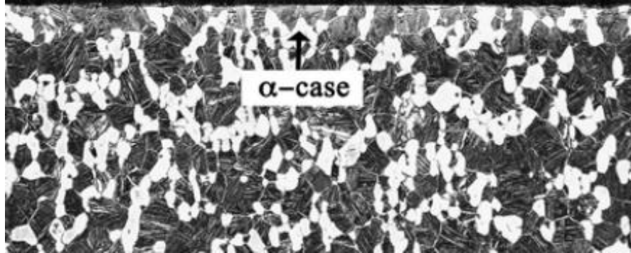
Figura 3.26 Fenomeno dell'α-case sullo strato superficiale del materiale [48]
