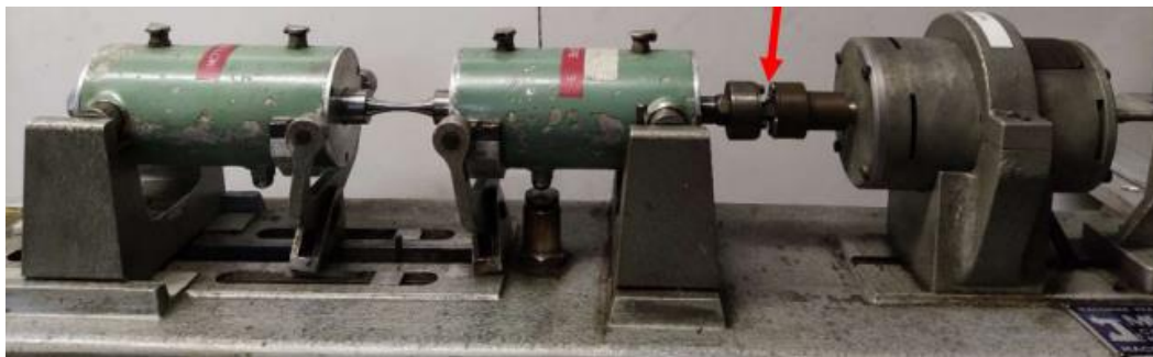
Figura 5.4 Macchina della prova a flessione rotante presente in laboratorio Tecnologie Meccaniche dell'Università degli studi di Padova, a Padova [1]
