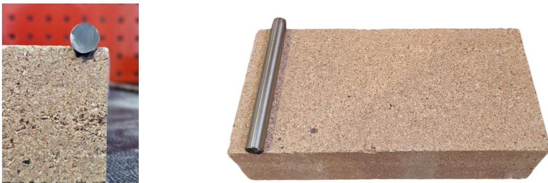
Figura 3.1 Visione del materiale refrattario con la barra in Ti6Al4V. È possibile notare il solco iniziale per il posizionamento del provino e il materiale grezzo ancora da lavorare.
