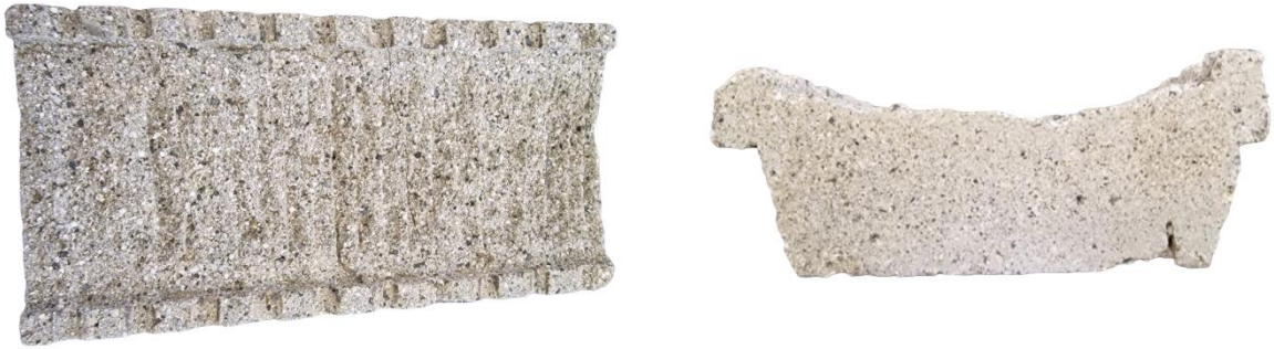
Figura 3.2 Materiale refrattario post lavorazione. Il cambio di colore è dettato dai trattamenti termici a cui è stato sottoposto, all'interno del forno, insieme ai provini.
