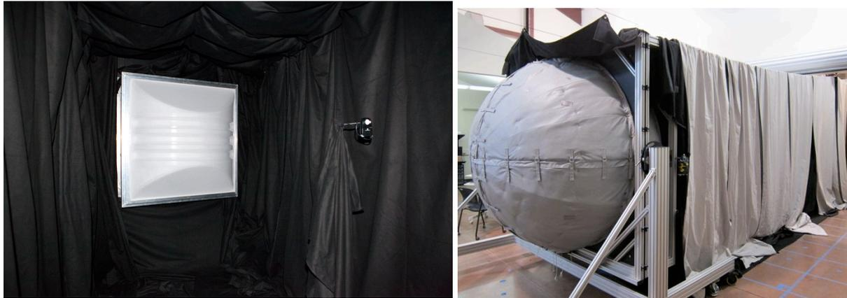
**Figura 3 – Veduta frontale e laterale del sistema di misura per lucernari statici ed automatici basato sull'utilizzazione della sfera di Ulbricht. Il sistema è stato sviluppato e testato in collaborazione con UC Davis California Lighting Technology Center**
