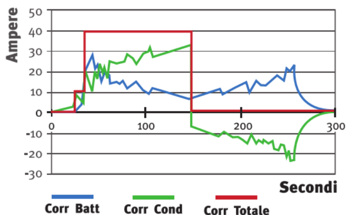
Fig. 4.27 Ripartizione corrente con accoppiamento batteria/supercondensatore (corr = corrente)
