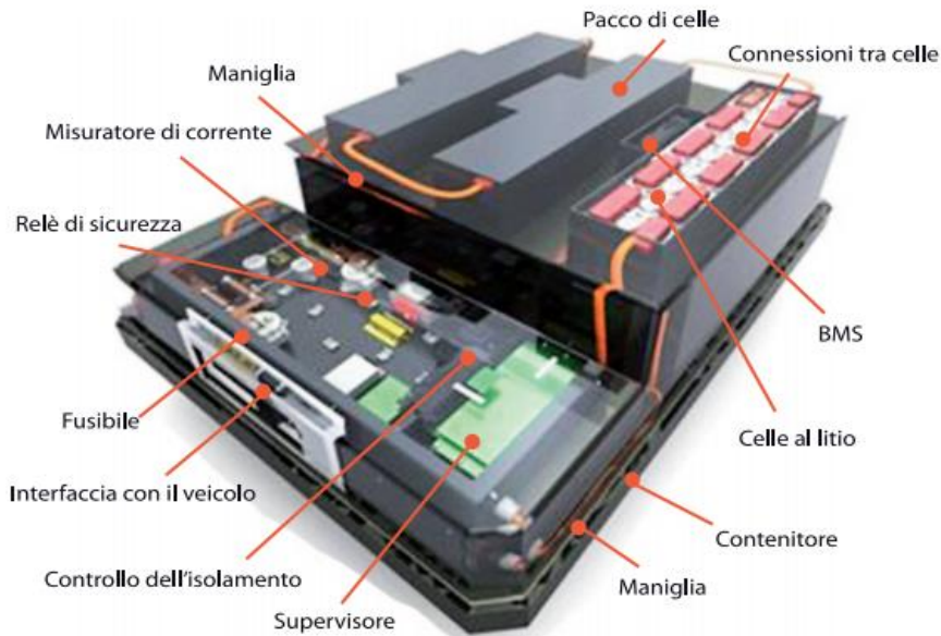
Fig. 4.8 Implementazione sistema alimentazione veicolo elettrico
