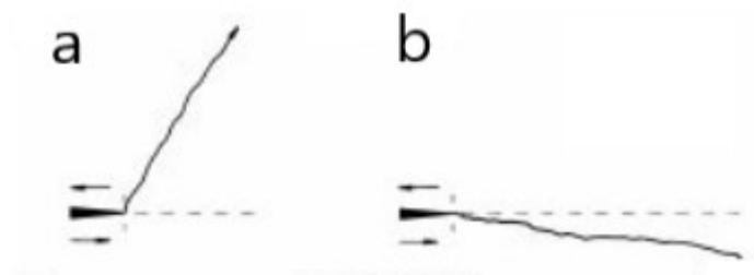
Figura 4.11: comportamento per impatti a bassa velocità (a) e alta velocità (b). Tratto da [15].
