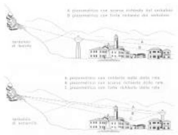
Fig 1_serbatoi di testata o di estremità.
