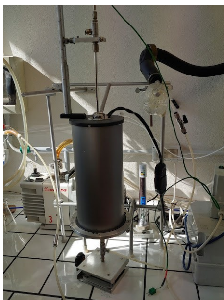
Fig. 56: immagine del dettaglio del reattore in quarzo contenente il catalizzatore (a) e pronto per essere posto nel riscaldatore (b); in basso (c) è rappresentato l'intero set-up sperimentale costituito dal reattore la cui uscita è connessa con il gas-cromatografo, il quadrupolo, e, fuori immagine, la cella per gas/FTIR.
