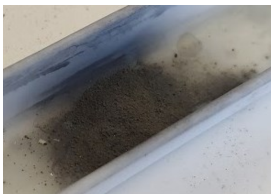
Figura 14. Primo campione dopo trattamento termico riducente
