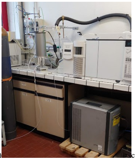
Fig. 56: immagine del dettaglio del reattore in quarzo contenente il catalizzatore (a) e pronto per essere posto nel riscaldatore (b); in basso (c) è rappresentato l'intero set-up sperimentale costituito dal reattore la cui uscita è connessa con il gas-cromatografo, il quadrupolo, e, fuori immagine, la cella per gas/FTIR.
