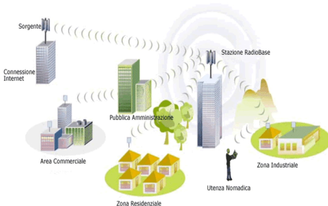
Figura 3.10: Esempio di rete HiperLAN.
