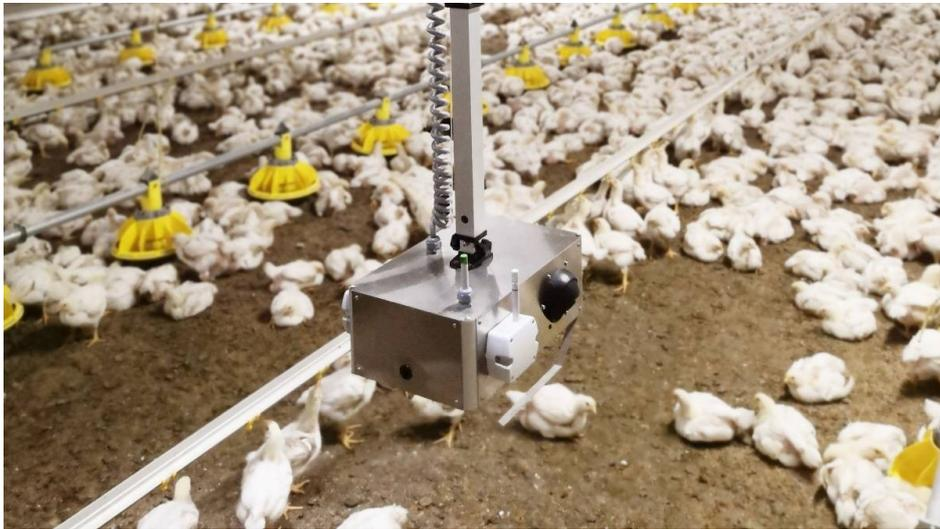
*Figura 4 Robot autonomo ChickenBoy per il monitoraggio di allevamenti avicoli*
