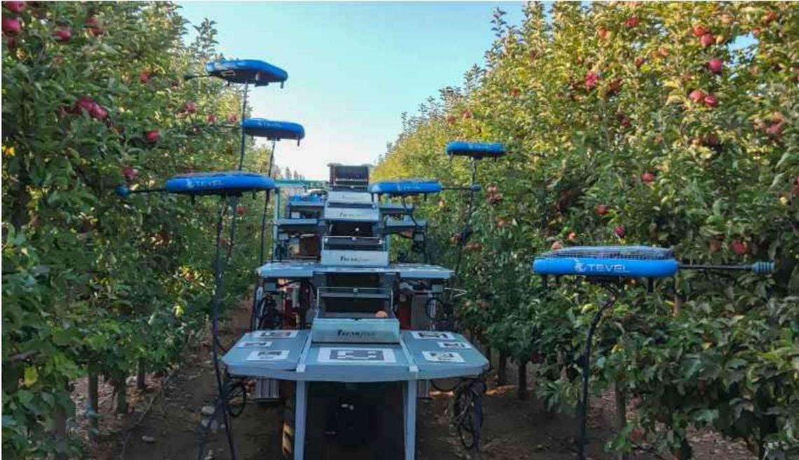
Figura 1 Robot Tevel autonomo per la raccolta di frutti maturi con prelievo diretto dalla pianta<sup>15</sup>
