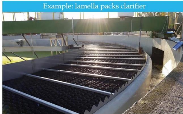
Sedimentazione con chiarificatore a pacchi lamellari
