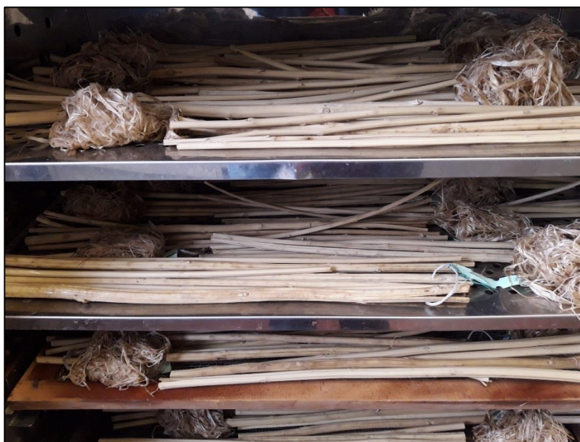
Figura 6 – Canapulo e fibra di canapa posti in stufa ad asciugare (CREA di Rovigo)
