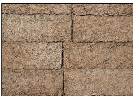
Figura 5 – Biomattone in canapa e calce (Amirante, 2020)
