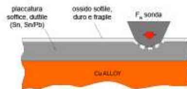
Figura 2.11 – Illustrazione schematica di un'interfaccia elettrica placcata in stagno.
