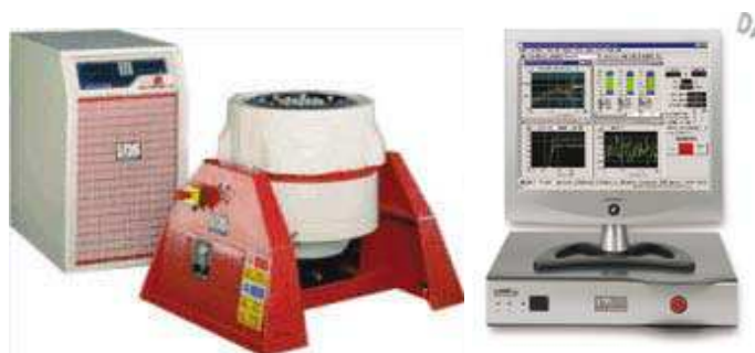
Figura 5.7 – Eccitatore elettromagnetico (a destra) con sistema di controllo delle vibrazioni (a sinistra).
