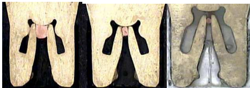
Figura 3.3 – Immagini reali di un terminale avente geometria compatibile con diverse sezioni di fili smaltati e cavi.
