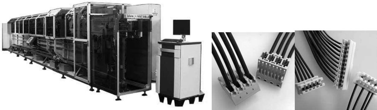
Figura 3.29 – Macchina automatica serie AHM EVOLUTION (a sinistra) ed applicazioni complete INAR-RAST (a destra).
