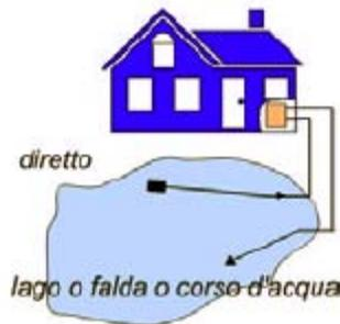
Figura 3.2 Schema di PDCG a circuito aperto che utilizza acqua di lago, di fiume o di falda come fluido termovettore
