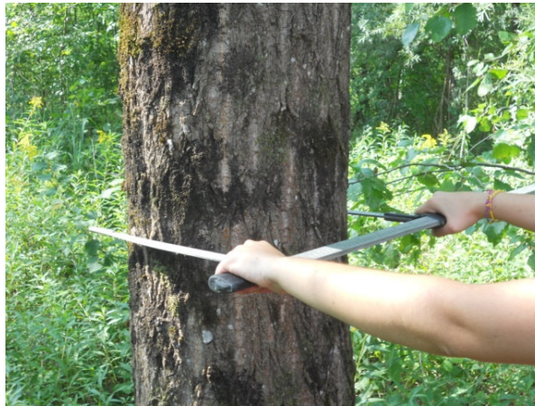
Figura 7.6: misurazione del diametro con cavalletto dendrometrico
