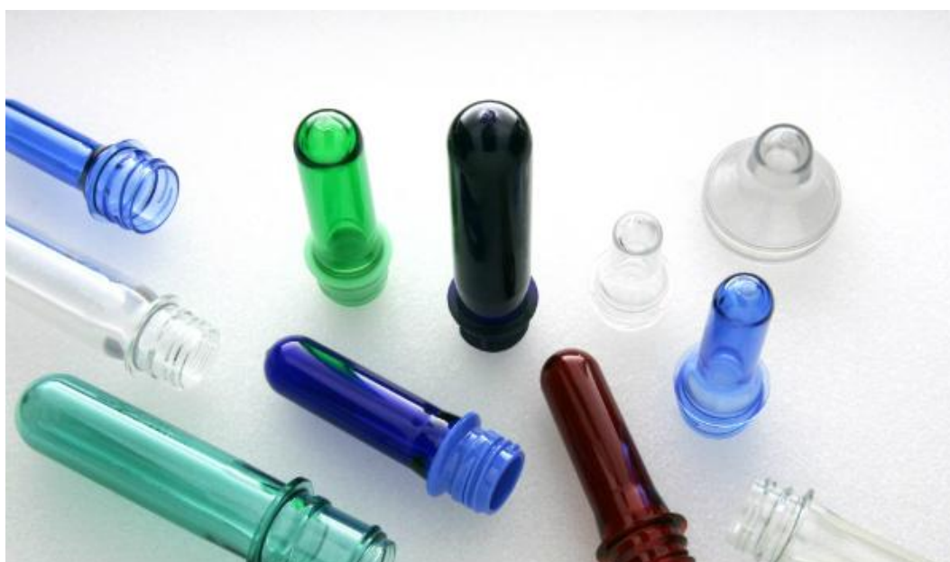
Figura 3.3: Esempi di preforme in PET (fonte: www.pressco.com )
