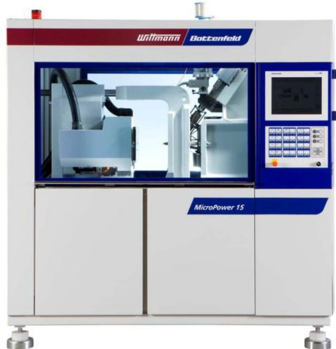
Figura 3.11: Pressa a iniezione Wittmann Battenfeld MicroPower 15 (fonte: www.kunststoff-schweiz.ch )
