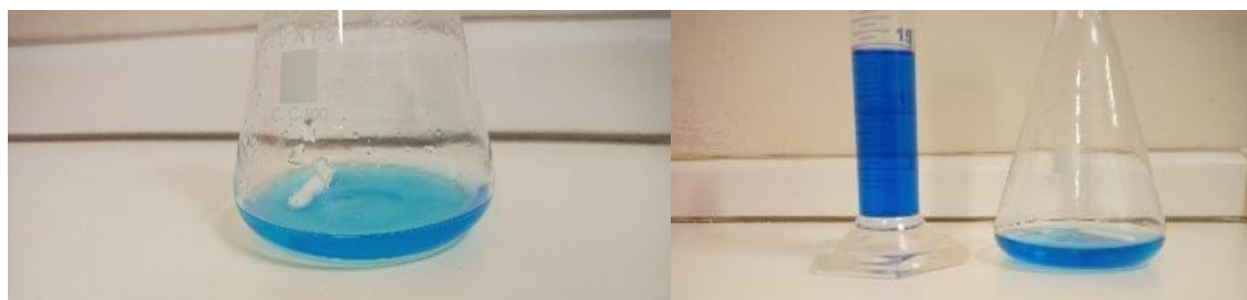
Fig. 4.10: riformazione del complesso Tetramminorame (sinistra) e confronto con la soluzione alcalina di partenza (destra, nel cilindro)
