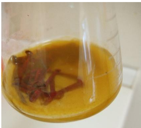
Fig.4.5: chiodi di Ferro ricoperti di Rame metallico in soluzione di Solfato Ferrico (Ruggine)
