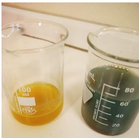
Fig. 4.7: soluzione di Solfato Ferrico prima (sinistra) e dopo (destra) l'aggiunta di Ammoniaca
