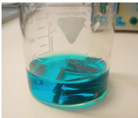
Fig. 4.3: chiodi di Ferro in soluzione acquosa di Rame Solfato
