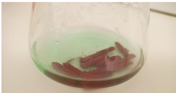
Fig. 4.4: chiodi di Ferro ricoperti di Rame metallico in soluzione di Solfato Ferroso
