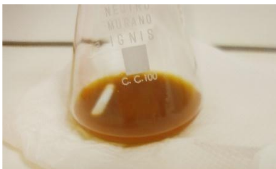
Fig. 4.12: formazione dell'Acido Gluconico e dell'Ossido di Rame (I).
