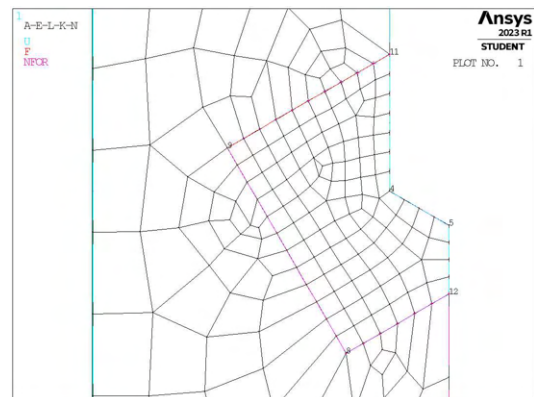
(d) Mesh raffinata, H_r = 10\text{mm} , d_{global} = 7.083\text{mm} .
