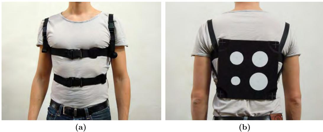
Figura 2.4: *Target-pilot*: fissaggio del target al pilota. Si notano le cinghie elastiche attorno al torace e le due chinghe attorno alle spalle.
