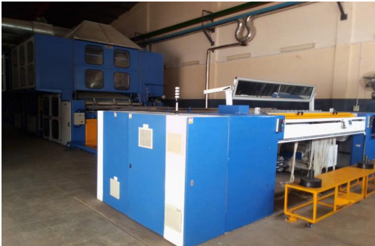
Photo 33 : Machine permettant l'impression des différents modes et designs du tissu
