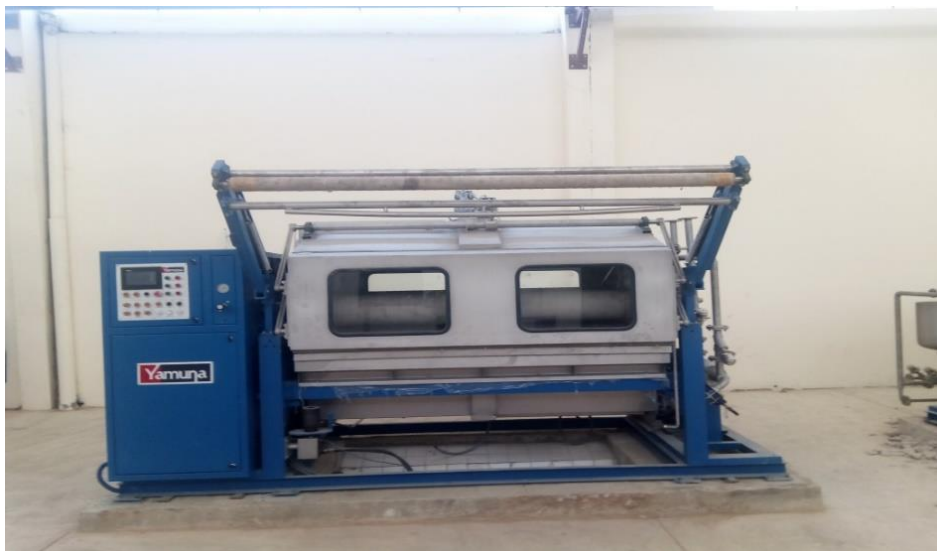
Photo 28 : Machine à teintée (Jigger)
