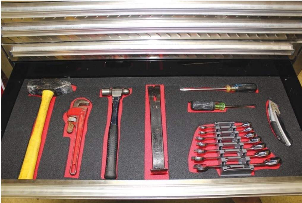
Fig. 4.15: Postazione in cui vengono collocati i vari strumenti necessari all'operatore, in cui ognuno di essi ha un preciso posto assegnato ( https://www.accuform.com/organization-5S-Lean/foam-tool-organizer-PDF100 ).
