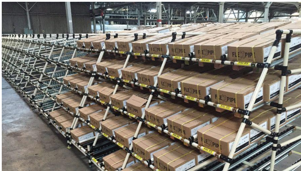
Fig. 4.11: Esempio di supermarket in cui si nota l'inclinazione delle corsie per permettere il carico dalla parte posteriore con il conseguente avanzamento per gravità dei colli, in modo tale che siano accessibili per il prelievo del water strider dalla parte frontale del supermarket stesso ( https://www.latestquality.com/lean-supermarket/ ).
