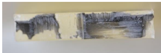
Figura 7.25 Rottura stelo del provino per un laminato vergine
