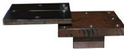
Figura 5.18 Supporto provini per esecuzione prova di trazione
