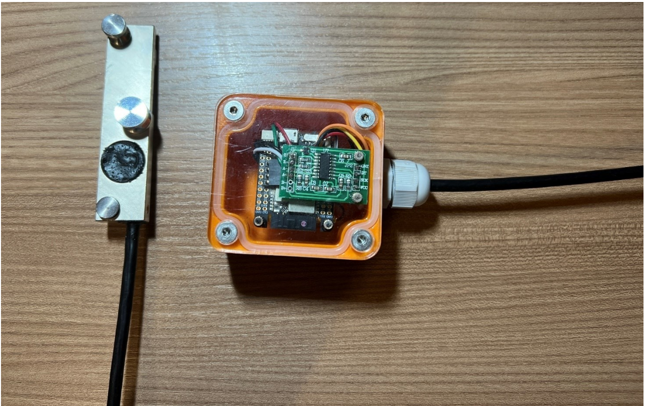
Figura 3.3: componente SailTrack Strain dotato della cella di carico e relativa circuiteria.
