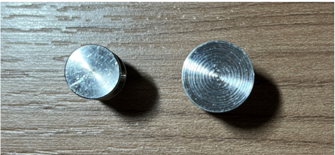
Figura 3.7: pioletto di fabbrica a sinistra e a destra quello nuovo costruito.
