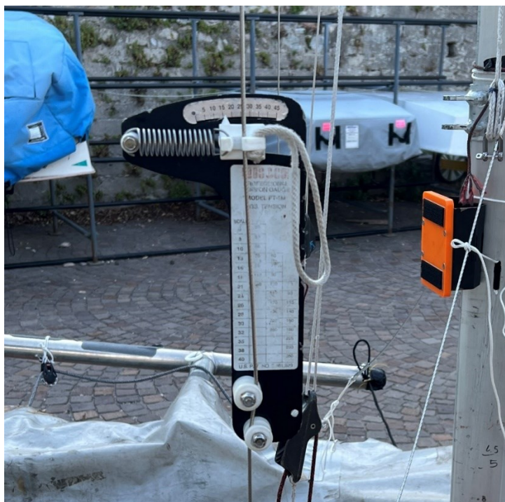
Figura 4.1: tensiometro attaccato alla sartia dell'imbarcazione per verificarne il carico.
