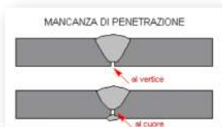
Figura 16 Rappresentazione mancanza di penetrazione
