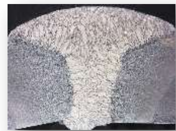
Figura 52 Saldatura giusta velocità, si noti il buon cordone
