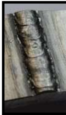
Figura 69 Buona finitura superficiale, PB_1
