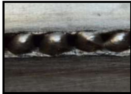
Figura 69 Pessima finitura superficiale, PB_4
