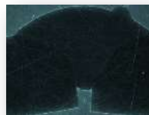
Figura 17 Esempio mancata penetrazione in C18_9
