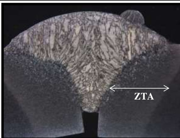
Figura 61 Campione attaccato Nithal 3, C18_4
