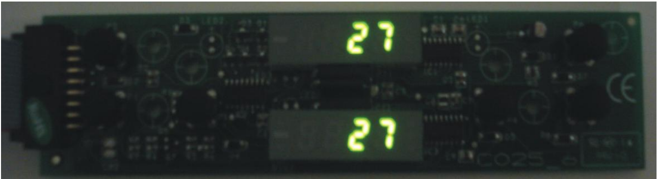
Figura 12 – Verifica memorizzazione temperatura in EEPROM (contenuto RAM = contenuto EEPROM)
