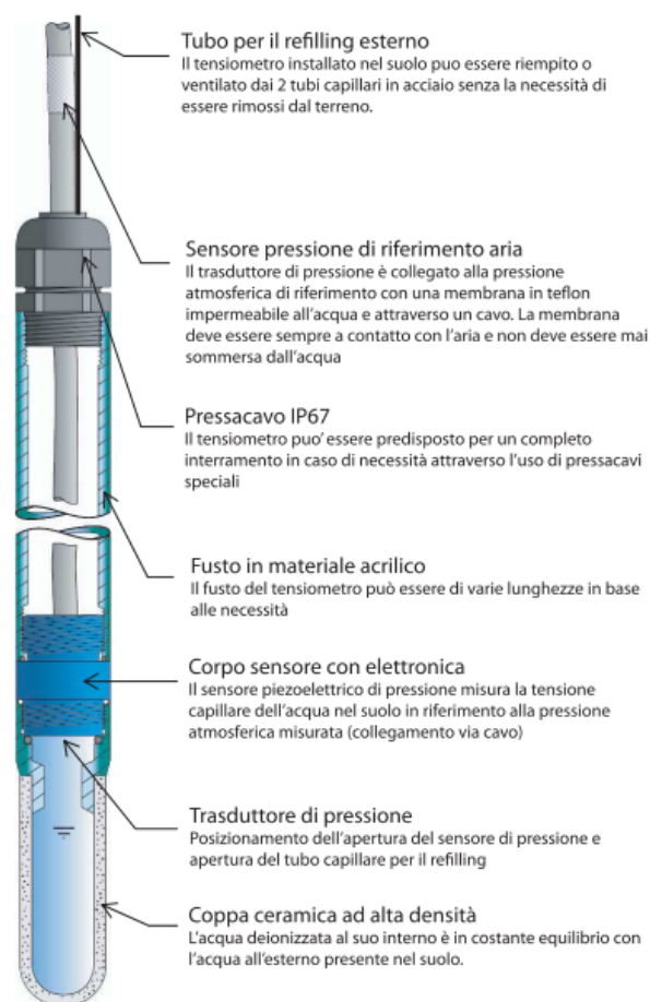
Figura 2.9 Descrizione schematica dei tensiometri elettronici T4e.
