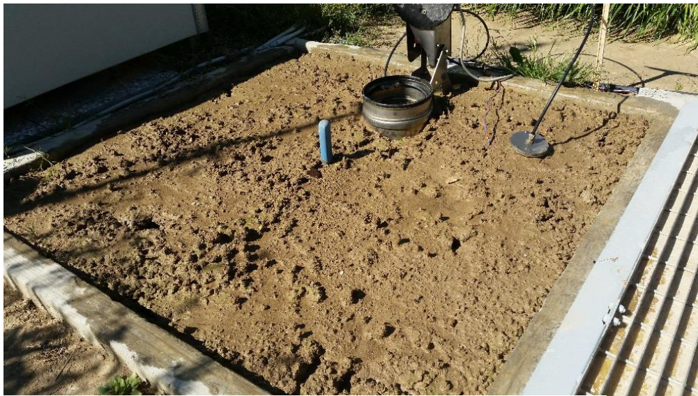
Figura 2.3 Lisimetro in assenza di coltura di copertura.
