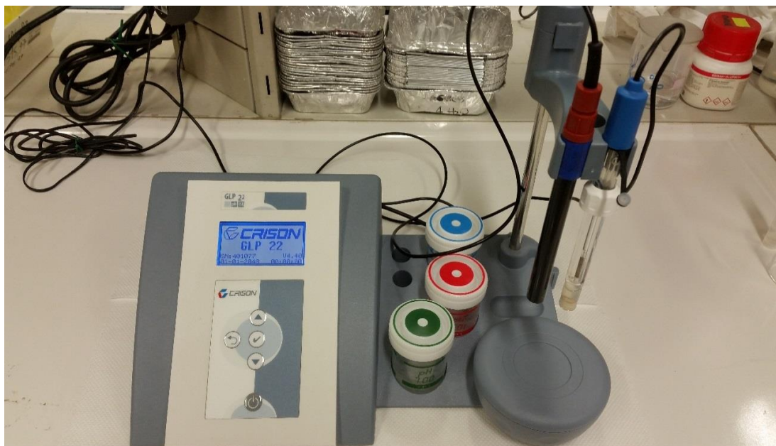
Figura 2.12 Strumentazione per l'analisi dello ione bromuro.
