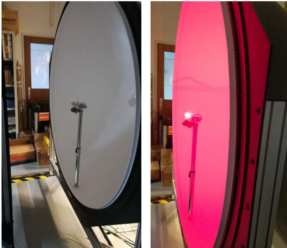
Figura 5.3: Posizionamento all'interno della sfera integratrice (sfera aperta per esigenze fotografiche)
