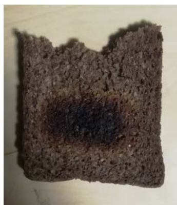
Figura 8.14: Campione di pane integrale dopo la prova con prototipo royal blue polarizzato a 2 A: al centro è visibile la bruciatura
