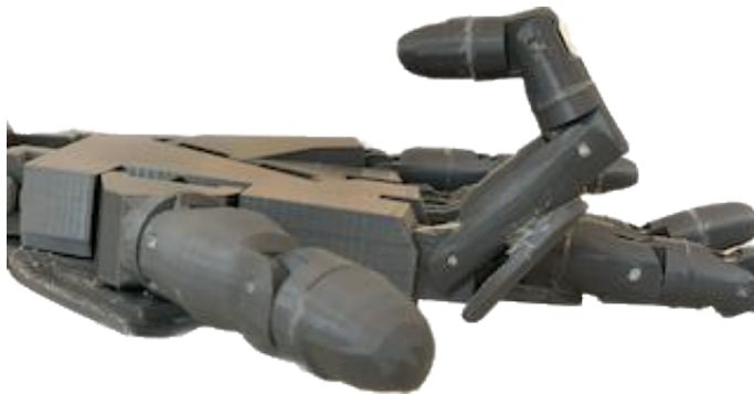
Figura 4.6: Meccanismo del dito, posizione contratta da visione laterale - progettazione meccanica
