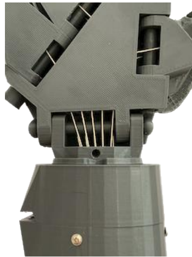
Figura 4.10: Dettaglio del meccanismo del polso in posizione normale - progettazione meccanica
