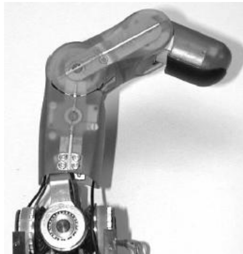
Figura 2.2: Dettaglio catena cinematica del dito, Mano - DRL
