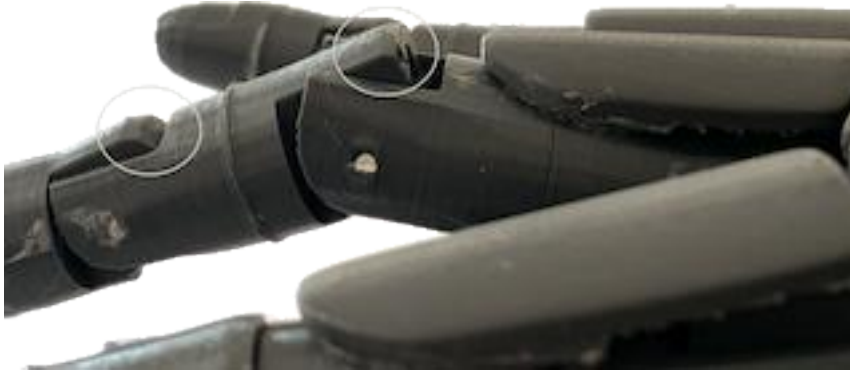
Figura 4.9: Dettaglio del meccanismo di fine corsa del dito medio - progettazione meccanica
