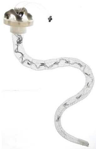
Figura 1.4: Esempio di tentacolo realizzato con materiali morbidi
