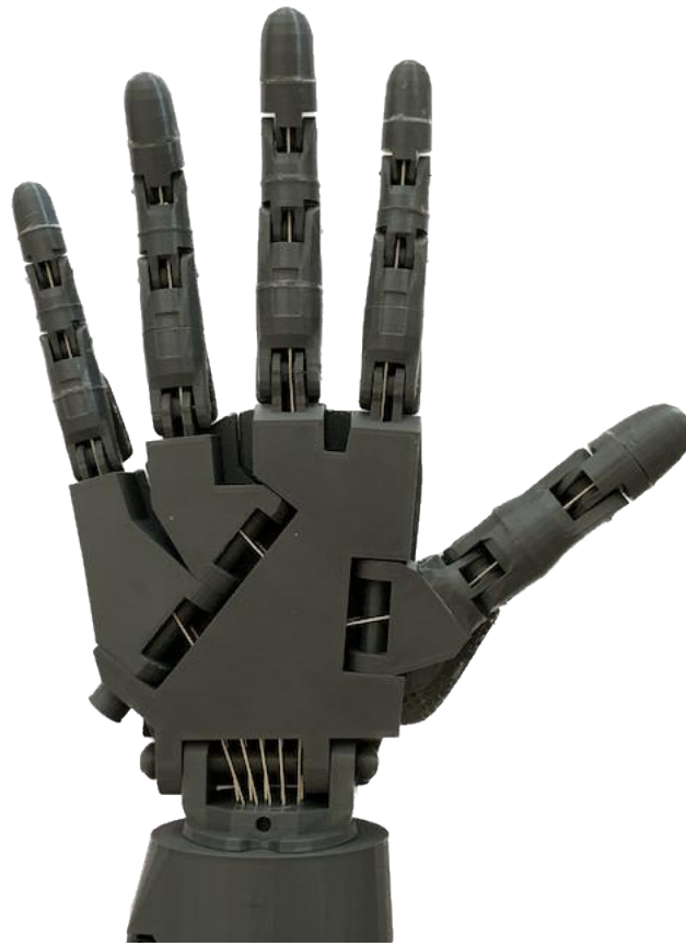
Figura 4.1: Meccanismo della mano, posizione rilassata - progettazione meccanica
