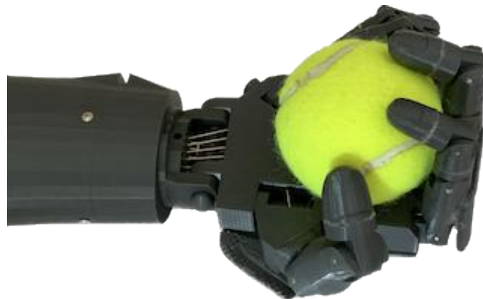
Figura 4.8: Presa adattiva coordinata delle dita su una pallina da Padel
