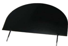
Figura 4.9: Strumentazione - martinetto piatto
