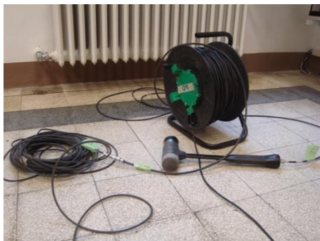
Figura 4.1: Strumentazione prova sonica. Martello e accelerometro
