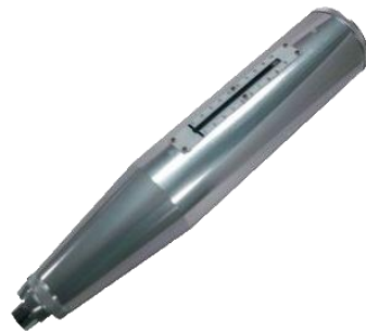
Figura 4.5: Strumentazione della prova con sclerometro
