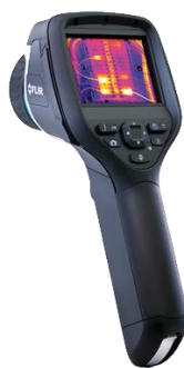
Figura 4.4: Strumentazione per la prova termografica
