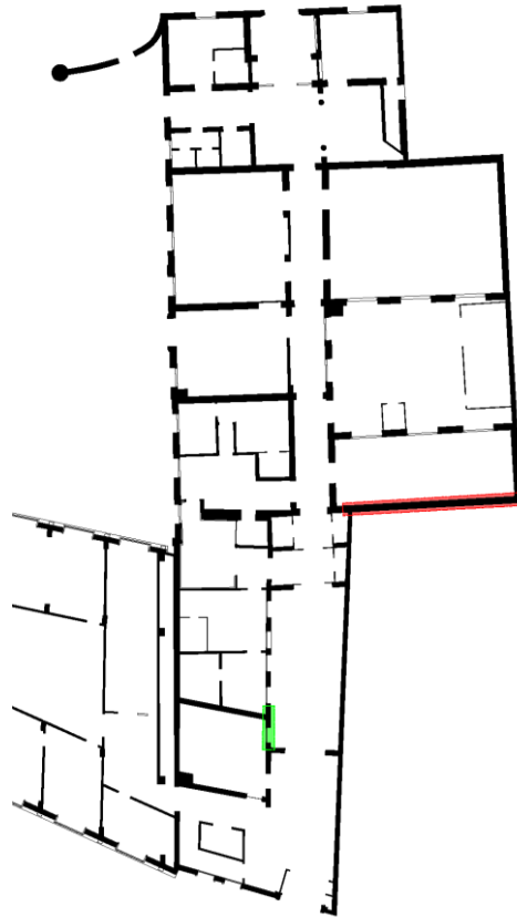
Figura 6.11: Pianta del corpo D – In rosso il setto con l'indice I2 minimo e in verde quello con l'indice massimo
