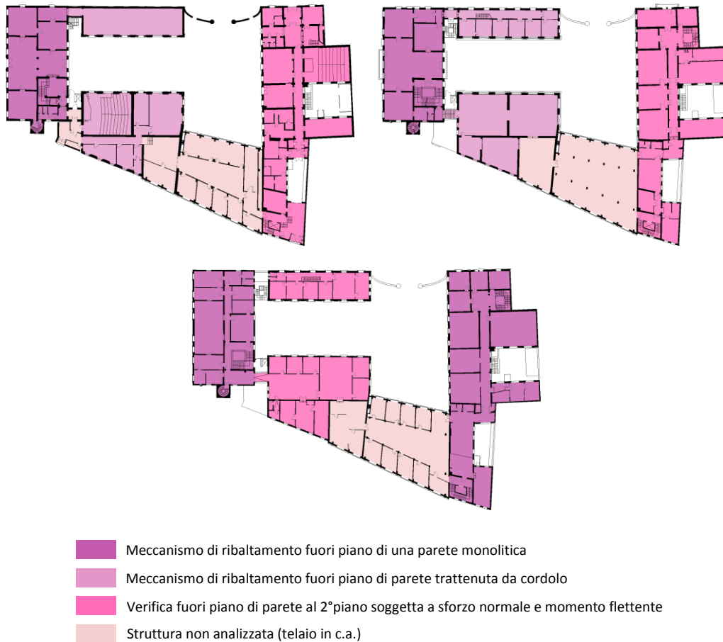
Figura 6.13: Meccanismi analizzati – Piani terra, primo e secondo
