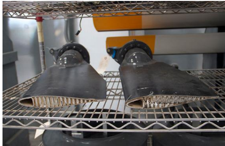
Figura 2.7 Sezioni di pale del rotore di un elicottero presso la Robinson Helicopter Company. Si possono notare le celle in posizione verticale, posteriormente al setto cavo in prossimità del bordo d'attacco (FlyingMag, 2017).
