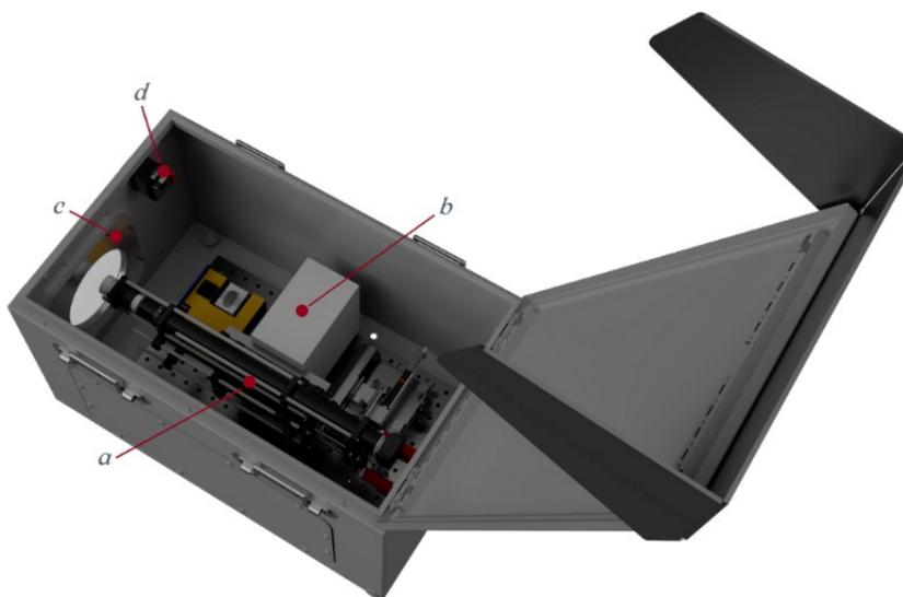
Figura 11: Render dell'apparato trasmittente con vista all'interno del contenitore. a) Telescopio ricevitore, b) Mount alt-azimut motorizzata, c) Supporto finestra ottica, d) Motore stepper per automazione shutter.
