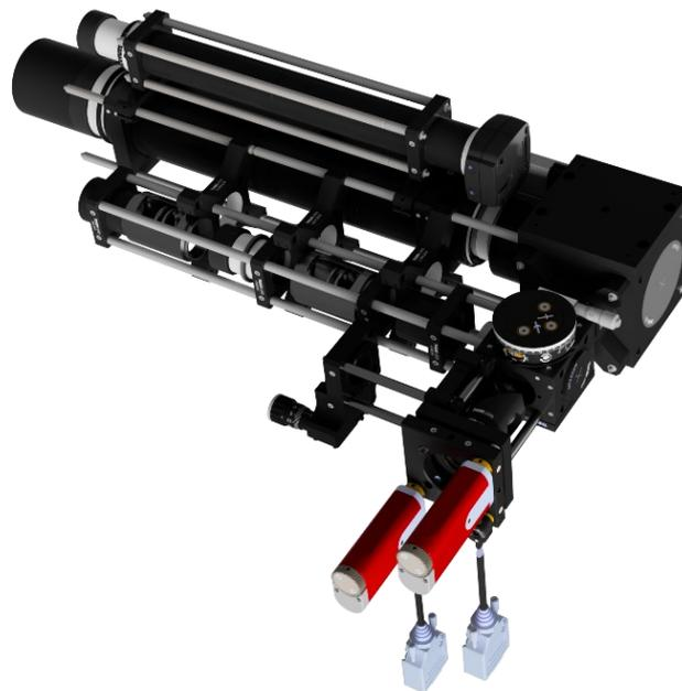
Figura 14: Render del telescopio ricevitore con stage per l'automazione dell'accoppiamento in fibra.
